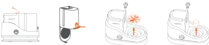
1. Поднимите фиксатор бака для снятия пылесборника
