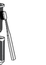
4. После очистки установите впускной фильтр на место до фиксации магнитом.
