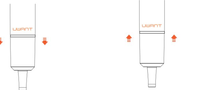
2. Фильтр потока воздуха крепится магнитом. Возмитесь за ручку и потяните воздушный фильтр прямо вниз, чтобы снять его с ручки.
